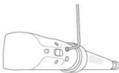
Entfernen Sie die Befestigungsschrauben der Kartusche mit einem 2.5-mm-Sechskantschlüssel von der Sattelklemme. Ziehen Sie die Kartusche heraus.
