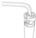
Entfernen Sie die untere Kappe mit einem 8-mm-Sechskantschlüssel.
