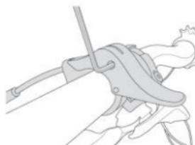
Verstellen Sie das Kabel so, dass die Kabelverkleidung, der Schaft und die Fernbedienung fest miteinander verbunden sind, der Bedienhebel richtig positioniert ist und die Kartusche sich problemlos bewegt. Ziehen Sie die Schraube mit einem 2-mm-Sechskantschlüssel fest. Das empfohlene Drehmoment: 1,2 Nm | 10 lbs-in | 12 kgf-cm
