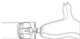
Befestigen Sie die untere Kappe mit der empfohlenen Drehmomenteinstellung.
