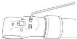
Führen Sie die Kartusche in das untere Sattelstützrohr bis zum Ende ein. Ziehen Sie die Befestigungsschrauben an.
